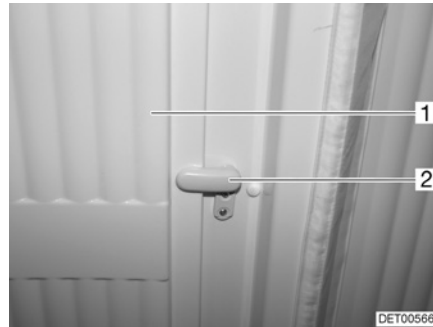
Kuva 112 Salpaus, WC-tilan verhous
