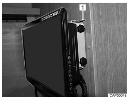
Kuva 47 Litteä kuvaruutu ajoasennossa
